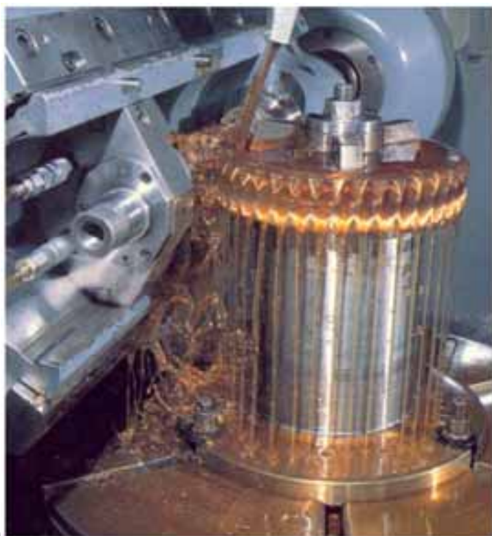
Machining of Covera toothing on worm wheel. Verzahnung von Schneckenrad
