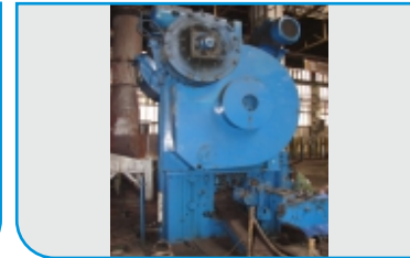
Erfurt SCPK 500 Billet Shear 500 Ton
